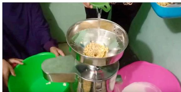
**Gambar 2. Penggilingan Kacang Kedelai dengan Mesin Pembuatan Susu Kedelai secara Otomatis**
