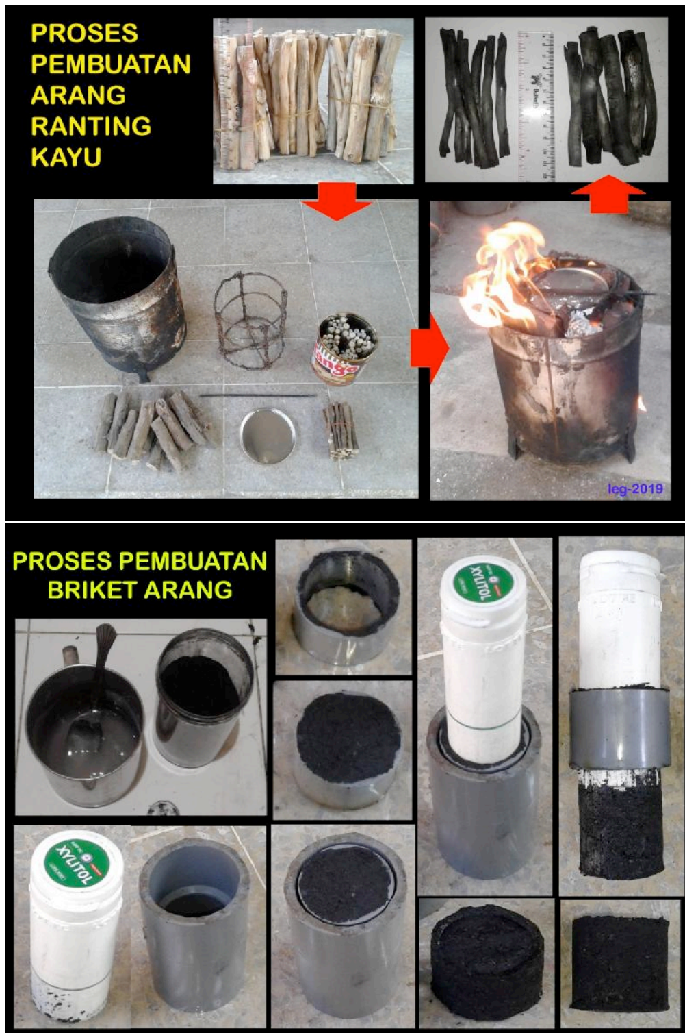
Gambar 1. Proses Pembuatan Arang dari Sampah Organik, Ranting Pohon dan Pembuatan Briket Arang
